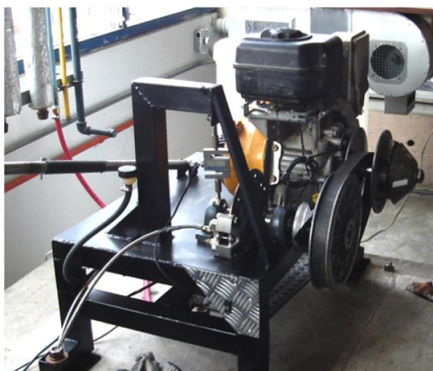
Figura 4.1 - Bancada de teste para obtenção da curva da TCV [Martínez et al., 2010]
