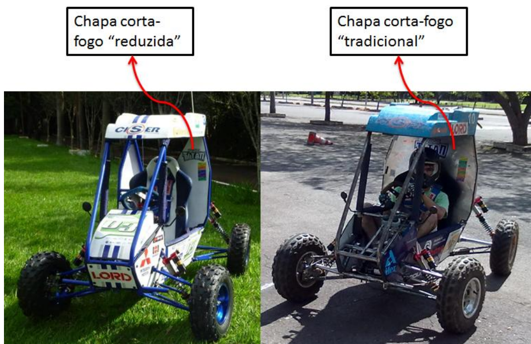
Figura 2.7 - Configurações da chapa corta-fogo
