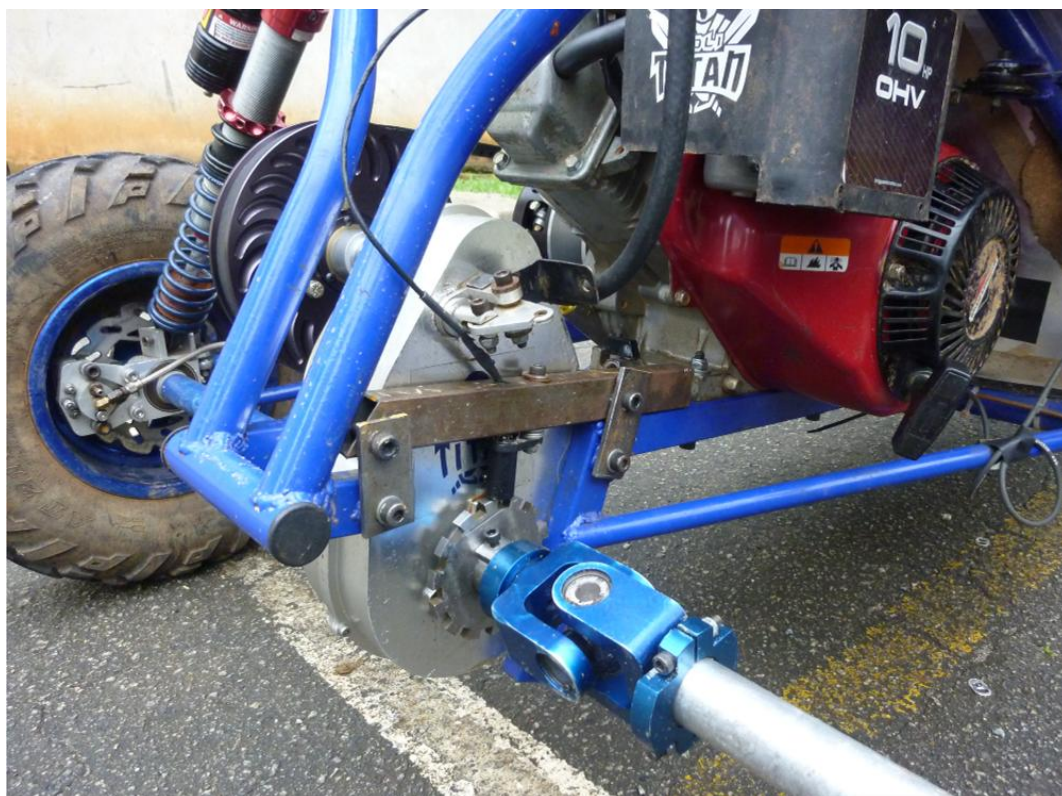
Figura 4.10 - Montagem do sensor de efeito Hall
