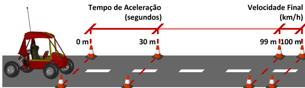
Figura 4.2 - Prova de aceleração e velocidade
