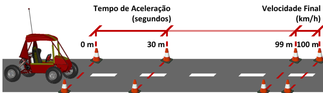
Figura 2.3 - Experimento realizado simulando as provas de aceleração e velocidade
