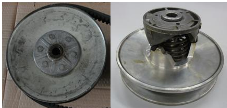
Figura 2.5 - Polia movida em aço (esq.) e em alumínio (dir.)
