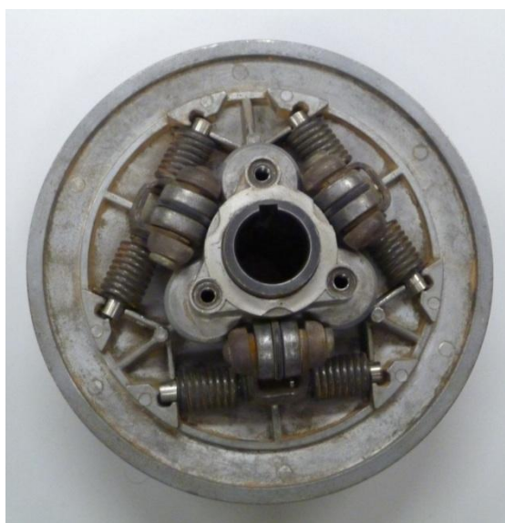
Figura 3.6 - Vista superior da polia motora da TCV
